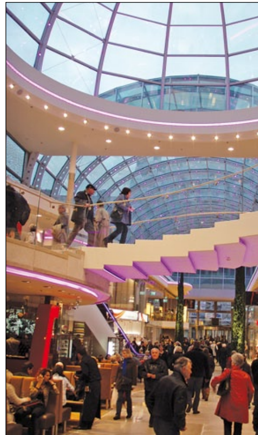
Selbst die Decken sind in diesem Einkaufszentrum – Lentia in Österreich – mit LEDs ausgestattet: „Es handelt sich um Eigenentwicklungen, um einzelne DMX-Leuchten mit 3-Watt-LEDs“, beschreibt Jürgen Lagerbauer „Sie haben jeweils eine eigene temperaturabhängige Leistungssteuerung. Jede LED entspricht einem Pixel – wie bei einer Videowand.“
